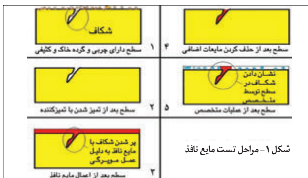
شکل ۲- تست مایع نافذ
